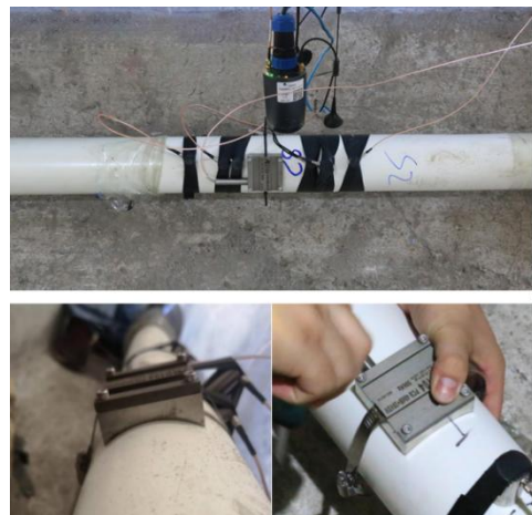
安装在拉索上的 RAEM1 智能传感器
