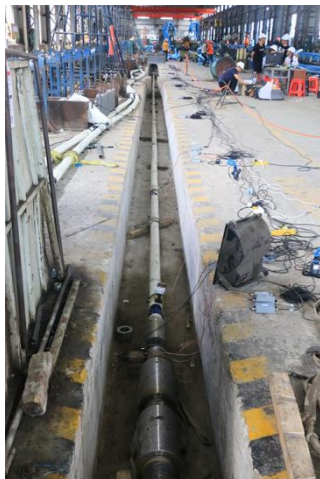
预制刻槽加载产生断丝的全尺寸拉索现场图
