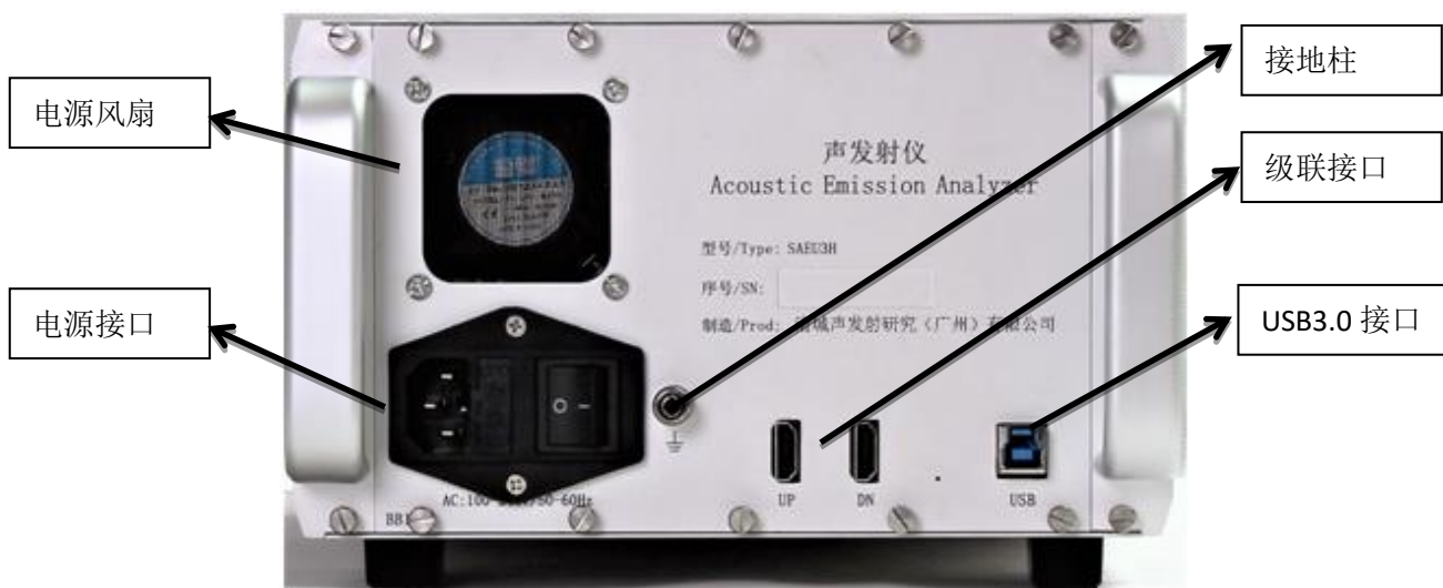
图 1-9 SAEU3H 后面板实物图
