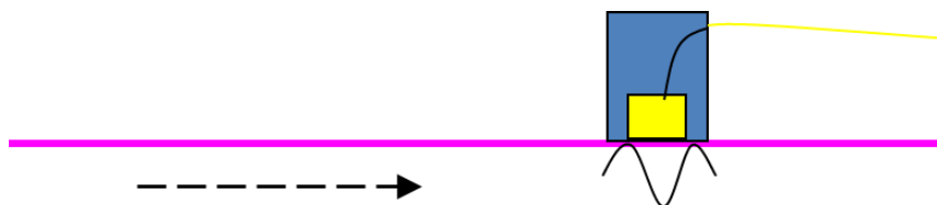
图 2-2 传感器接收表面波示意图
