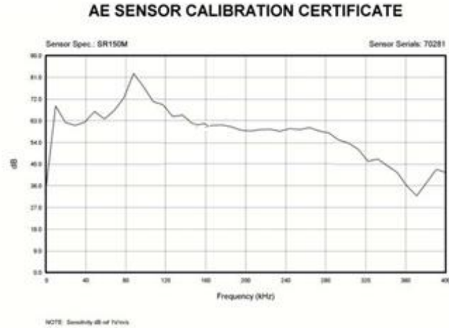
图 2- 14 二次校准后得出的传感器频响曲线图
